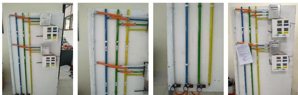
2. Foto simulasi bok panel *pressure transducer* dan pemasangan kabel sinyal.
