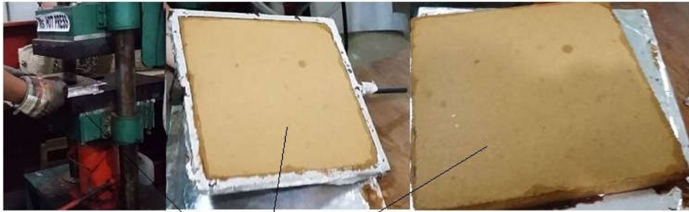
Hasil Panel Akustik setelah proses tekan panas ( hot press )
