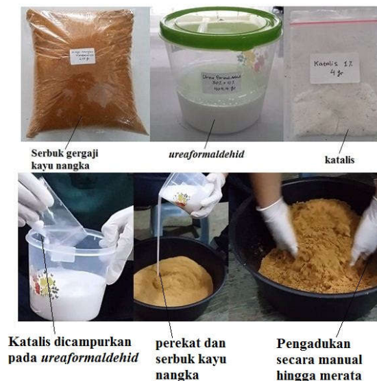
Gambar 4.4 Material spesimen panel akustik dan proses pencampuran material (Sumber : Dokumentasi Penulis, 2016)
