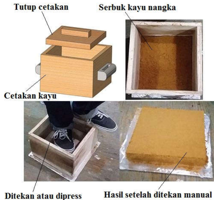
Gambar 4.2 cetakan kayu ( mat ) (Sumber : Dokumentasi Penulis, 2016)
