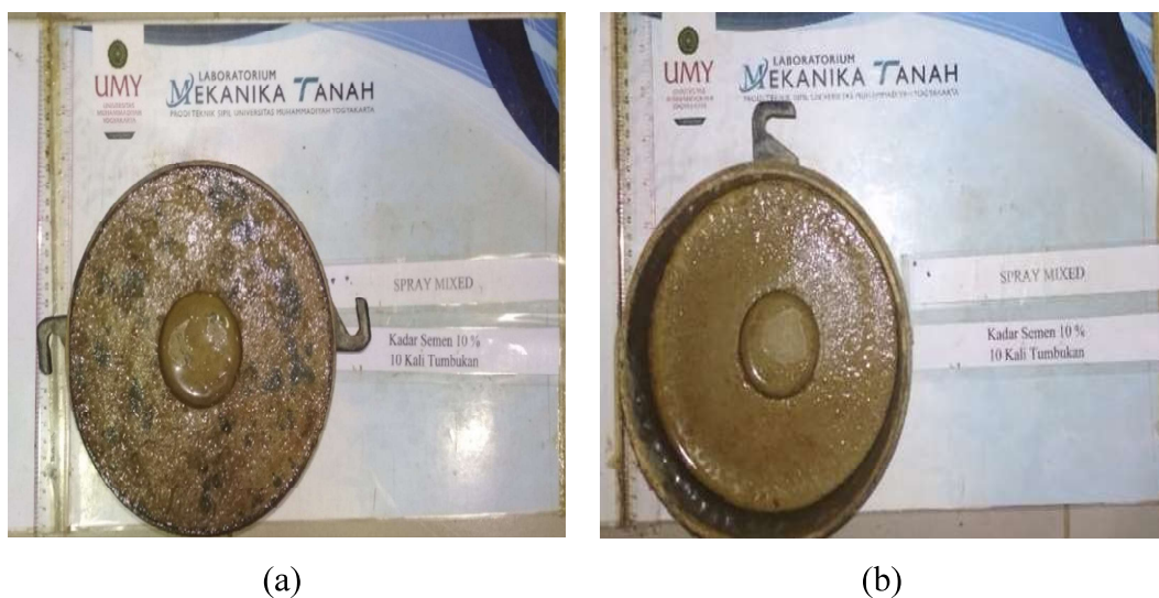
Gambar 4.13. Spesimen Uji CBR Kadar Semen 10% (a) Sisi Atas (b) Sisi Bawah
