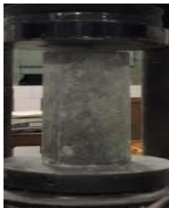
Gambar 1 Penempatan benda uji pada mesin uji tekan
