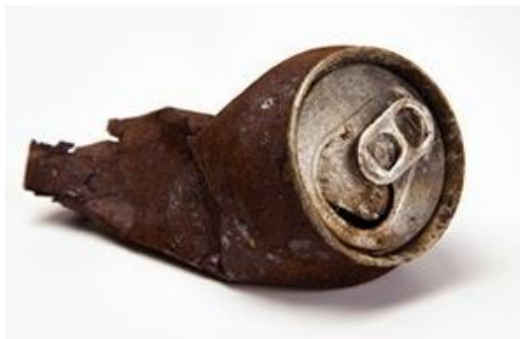
Gambar 2.1 Korosi Menyeluruh (mechanicalengineering, 2014)
