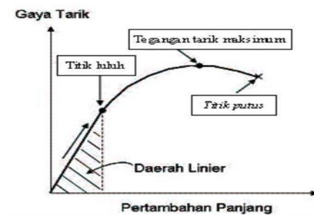
Gambar 2.3 Kurva hasil pengujian tarik berupa kurva gaya-perpanjangan
