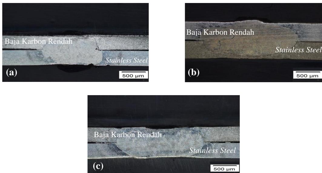
Gambar 4.4 Hasil pengamatan makro sambungan *spot welding dissimilar metal* tiap variasi tegangan listrik pengelasan (a) 1,79 Volt, (b) 2,02 Volt, (c) 2,30 Volt.
