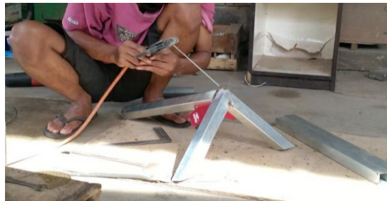
Gambar 3.4. Proses Pengelasan Tanpa Menggunakan Three Axis Fixture Vise
