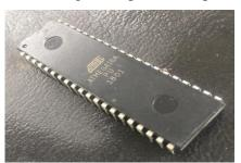
Gambar 2.19 Mikrokontroler ATmega16
