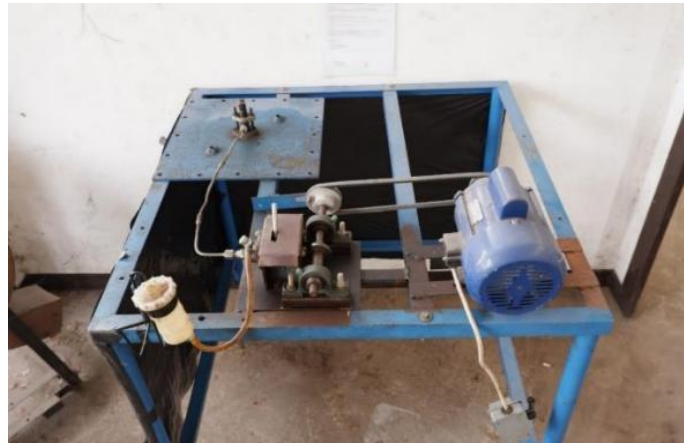
Gambar 3.5 Alat Uji Injeksi
