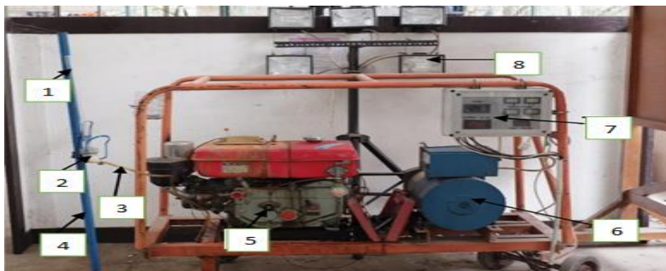
Gambar 3.4 Mesin Diesel dan Alternator
