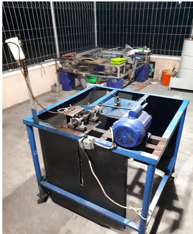
Gambar 3.22 Pengujian karakteristik injeksi
