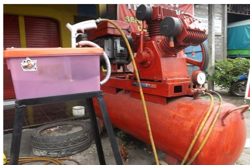
GAMBAR 3. Alat shot peening yang digunakan dalam perlakuan permukaan spesimen
