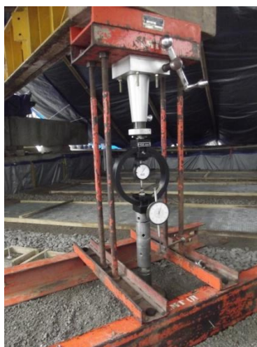
Gambar 5.31. Foto pengujian CBR sebelum pengembangan tanah
