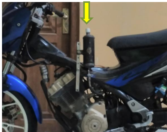
Gambar 3.18 Pemasangan tangki mini
