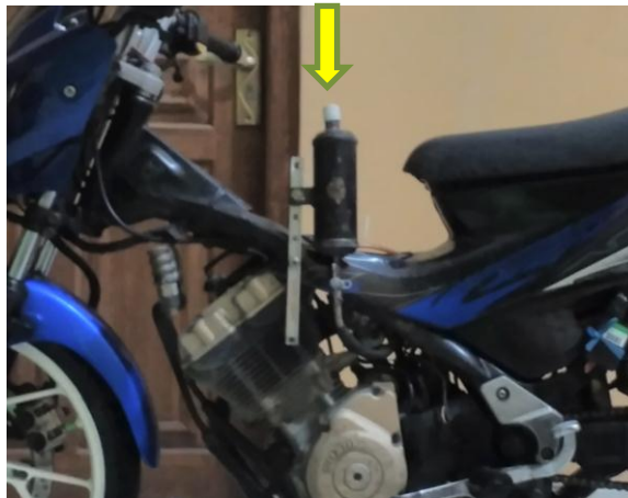
Gambar Pemasangan tangki mini
