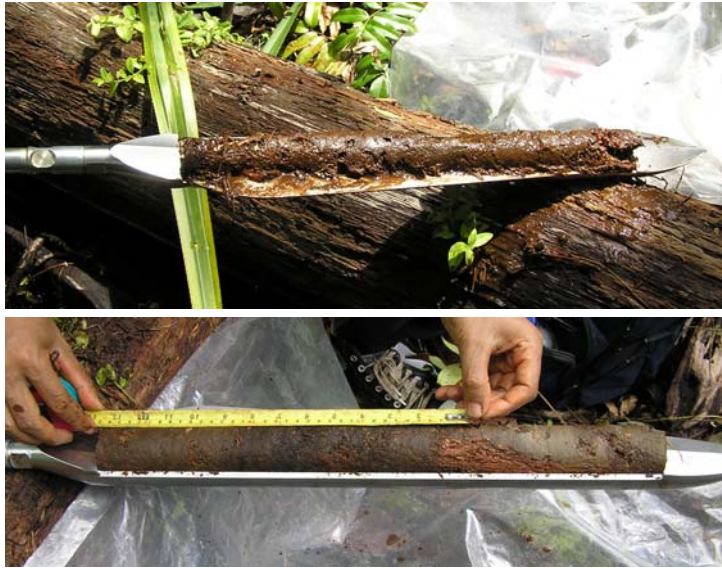
Gambar 2. Contoh tanah gambut yang diambil menggunakan bor gambut ( peat sampler ). Gambar atas memperlihatkan contoh gambut fibrik (mentah) dan gambar bawah contoh gambut hemik (setengah matang).
