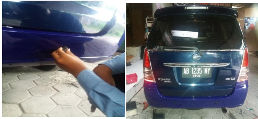
Gambar 4.18 Pemasangan sensor parkir dan pemasangan produk
