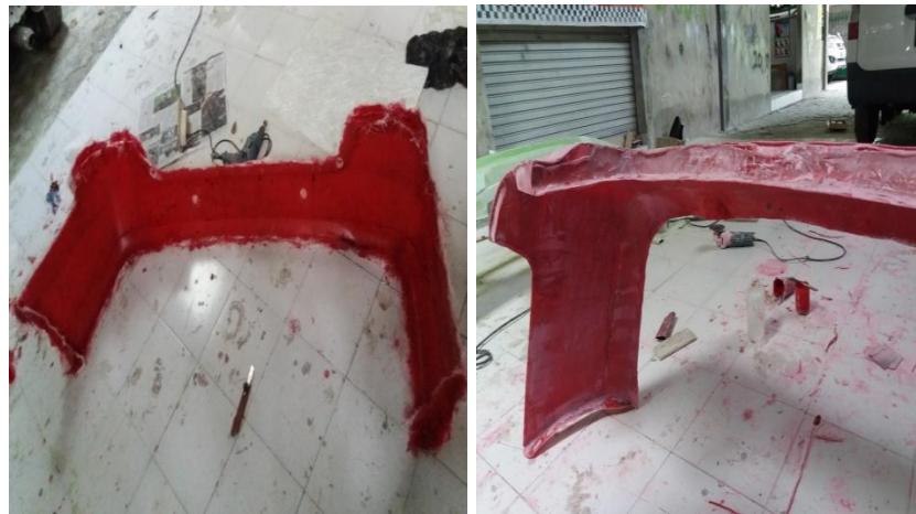
Gambar 2.23 Moulding sebelum dan sesudah di Cutting
