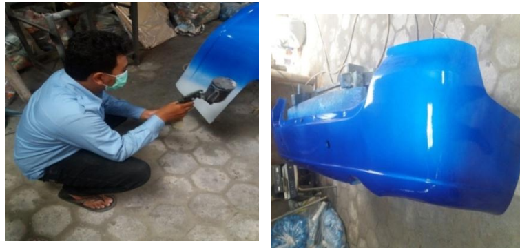
Gambar 4.16 proses pengecatan dan hasil pengecatan
