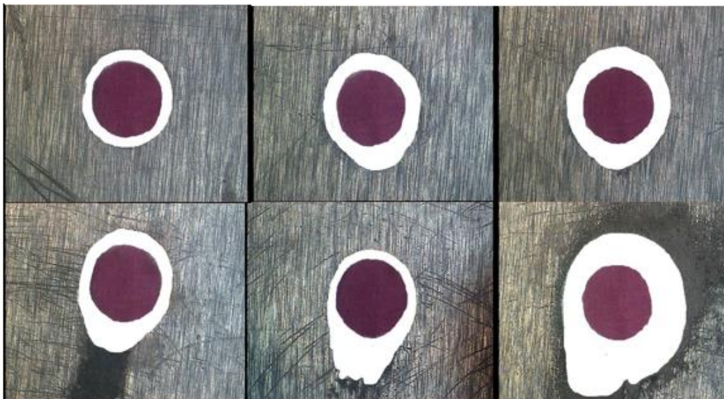
Lampiran 5. Hasil image-j overcut aluminium 1100 dengan gap 1 mm dan waktu pemesinan 193 detik, bagian depan (gambar atas), bagian belakang (gambar bawah)
