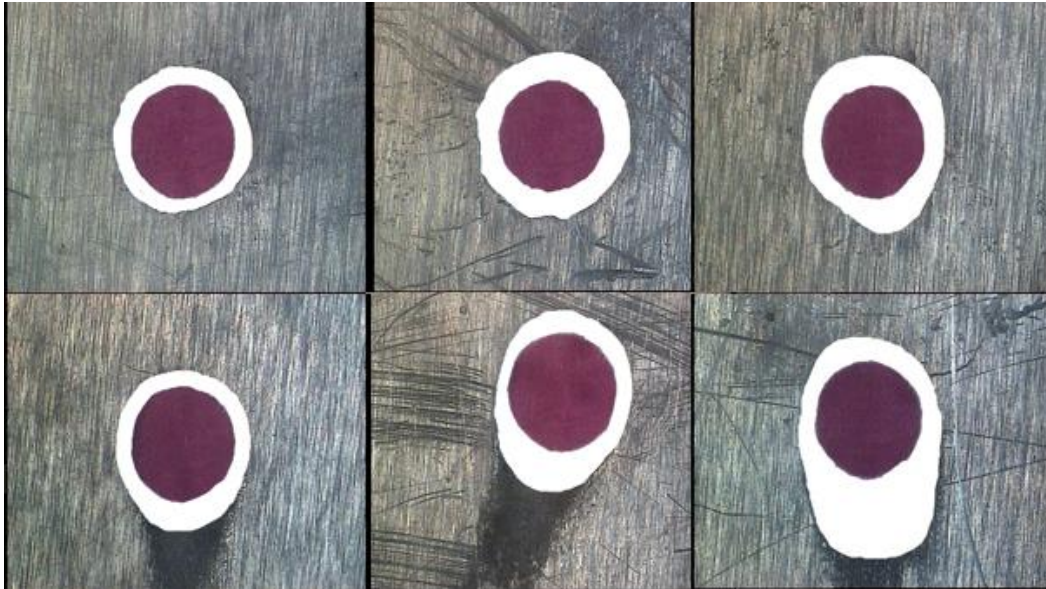
Lampiran 4. Hasil image-j overcut aluminium 1100 dengan gap 0,75 mm dan waktu pemesinan 186 detik, bagian depan (gambar atas), bagian belakang (gambar bawah)
