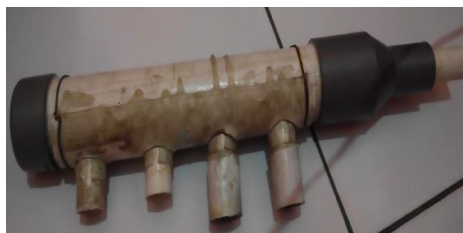
Gambar 3.8. Manifold dengan inlet segaris
