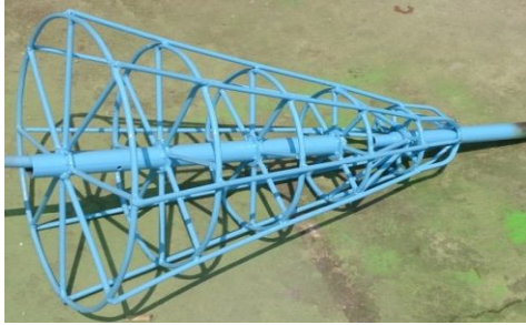
Gambar 3.5. Rangka kerucut sling pump
