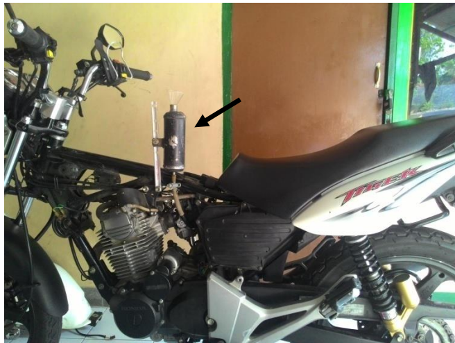
Gambar 3.17. Pemasangan tangki mini
