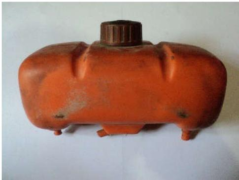
Tangki Mini A digunakan sebagai pengganti tangki standar pada pengujian kinerja mesin yang berfungsi untuk mempermudah penggantian bahan bakar.
