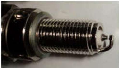
Busi TDR *Ballistic* memiliki elektroda yang terbuat dari *Platinum* dan diameter elektroda 1,1 mm.
