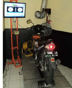
*Dynometer* digunakan untuk mengukur torsi dan daya sebuah mesin.
