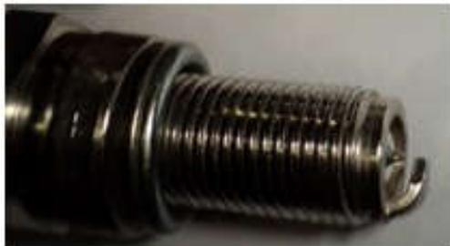
Busi Denso *Iridium* memiliki elektroda yang terbuat dari *Iridium* dan diameter elektroda 0,4 mm.
