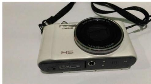
Kamera *High Speed* digunakan untuk mengambil gambar percikan bunga api busi.
