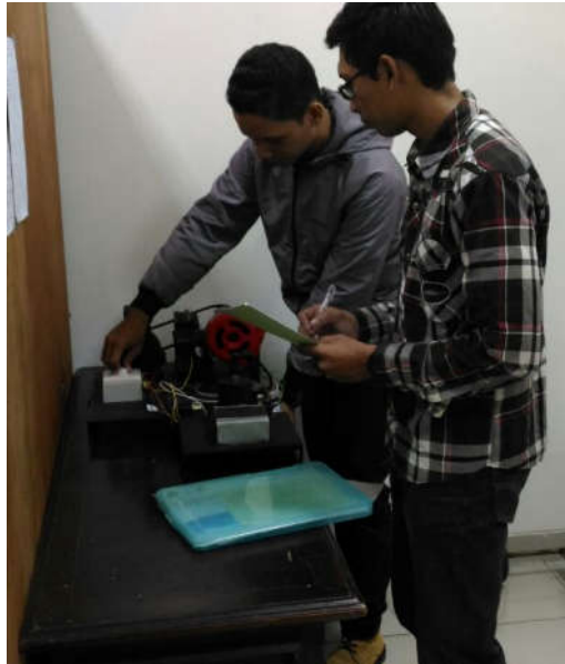
Gambar 3.22. Pengujian Percikan Bunga Api Busi
