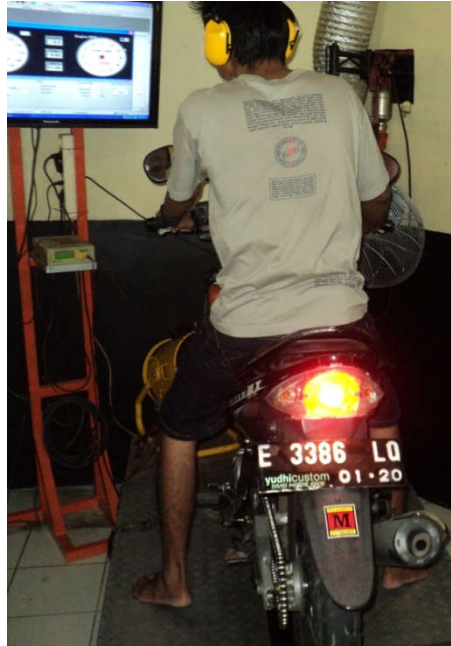
Gambar 3.23. Pengujian Kinerja Mesin
