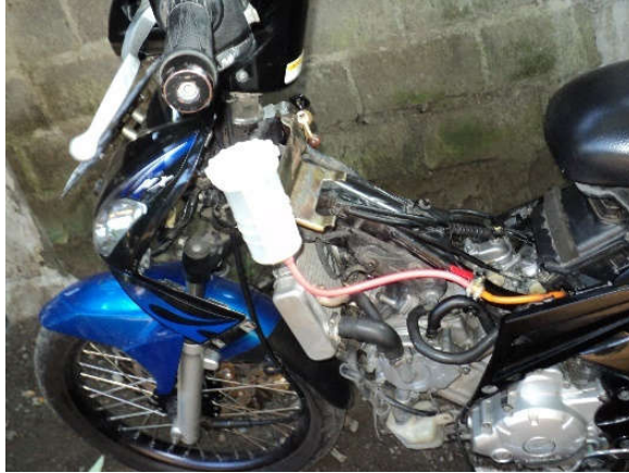
Gambar 3.24. Pengujian Konsumsi Bahan Bakar
