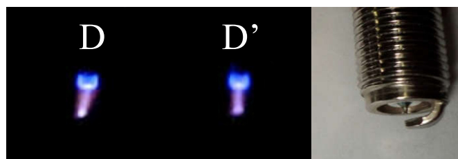
Gambar 4.6. Percikan Bunga Api Busi dengan Menggunakan Koil Standar (D), Koil KTC Racing (D'), dan Busi Denso Iridium Power
