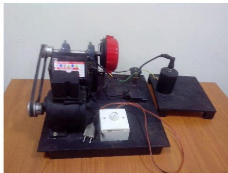
Gambar 3.17. Pengujian percikan bunga api
