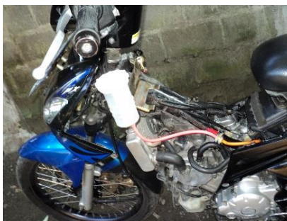
Gambar 3.19. Pengujian konsumsi bahan bakar
