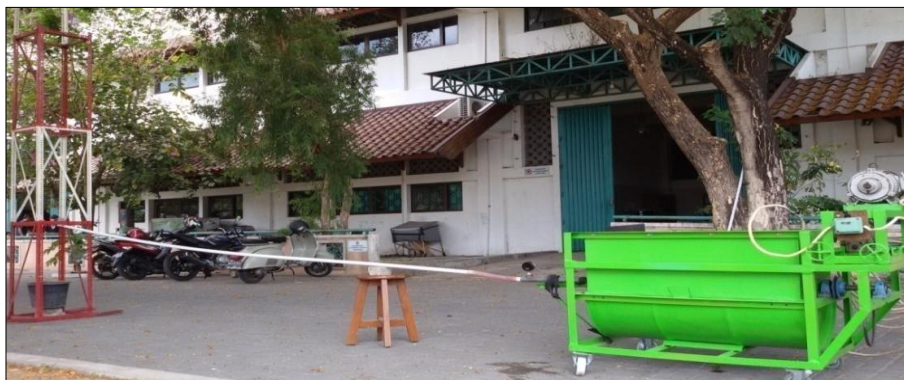
Gambar 3.2 Rangkaian keseluruhan Sling pump skala laboratorium
