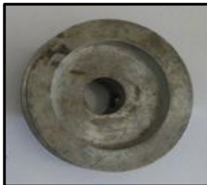
Gambar 3.4. Puli yang digunakan untuk putaran sling pump 30, 40, dan 50 rpm
