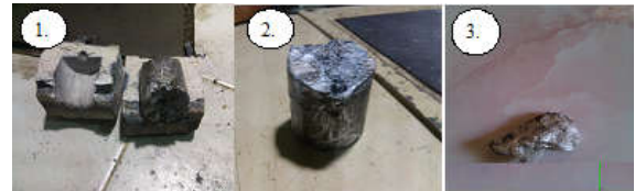
Gambar 4.7, (1). Proses pemisahan logam dengan tungku pelebur, (2). Logam dengan hasil peleburan dengan berat 152 gram dan, logam dengan massa peleburan 50 gram.
