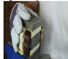
Gambar 3.3 Pemisahan tutup bawah konduktor yang di las
