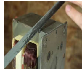
Gambar 3.2 Proses pemisahan kumparan dengan konduktor
