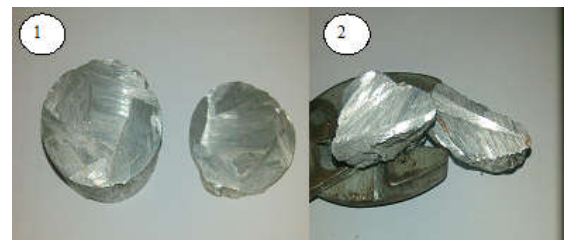
Gambar 4.8, (1) Permukaan bagian dalam dari hasil peleburan dengan massa 152 gram, dan
