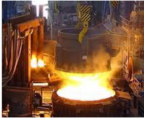
Gambar 2.6 tungku dapur busur listrik yang sedang beroperasi(Diakses dari http://viansteel.com )
