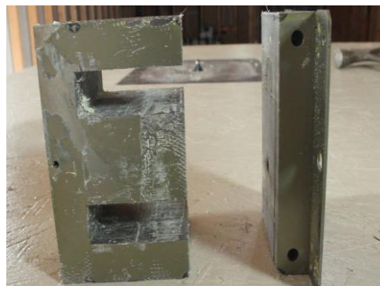
Gambar 3.4 Konduktor yang terpisah dengan kumparan
