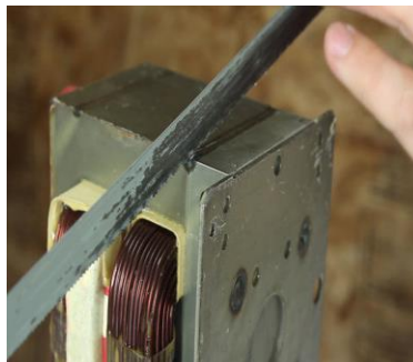
Gambar 3.2 Proses pemisahan kumparan dengan konduktor Kemudian setelah itu, pisahkan antara besi konduktor dengan kumparan tersebut,
