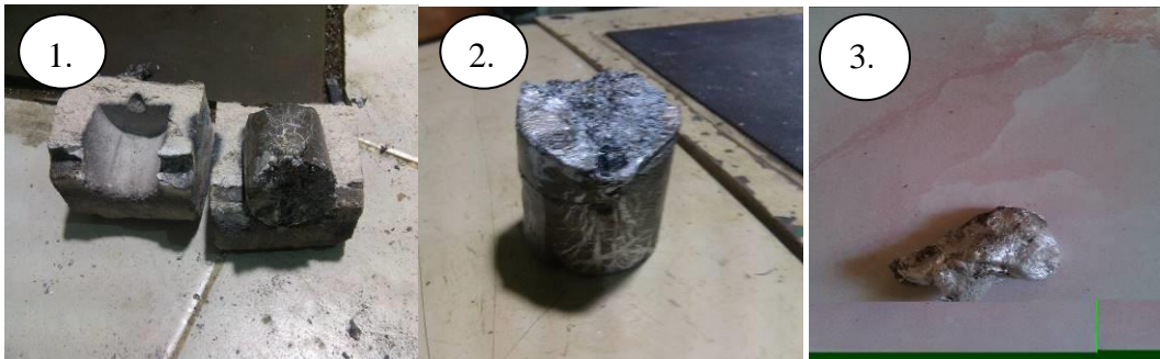
Gambar 4.7, (1). Proses pemisahan logam dengan tungku pelebur, (2). Logam dengan hasil peleburan dengan berat 152 gram dan, logam dengan massa peleburan 50 gram.
