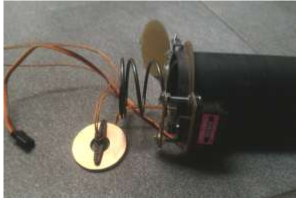
Gambar 3.16 Bagian Dalam Tabung Parasut
