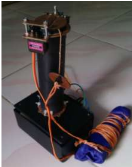
Gambar 3.19 Hasil Jadi Box Mikrokontroler Dan Tabung Parasut
