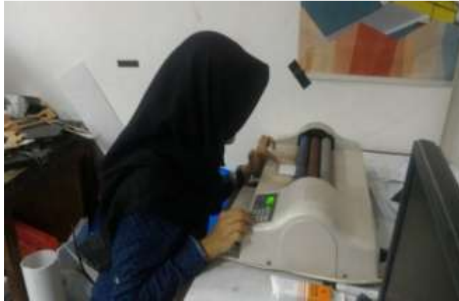
Gambar 3.9 Proses Pemindahan Skematik Rangkaian ke PCB
