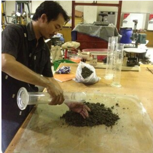
Gambar 4.4 Pencampuran tanah lempung dan pasir.
