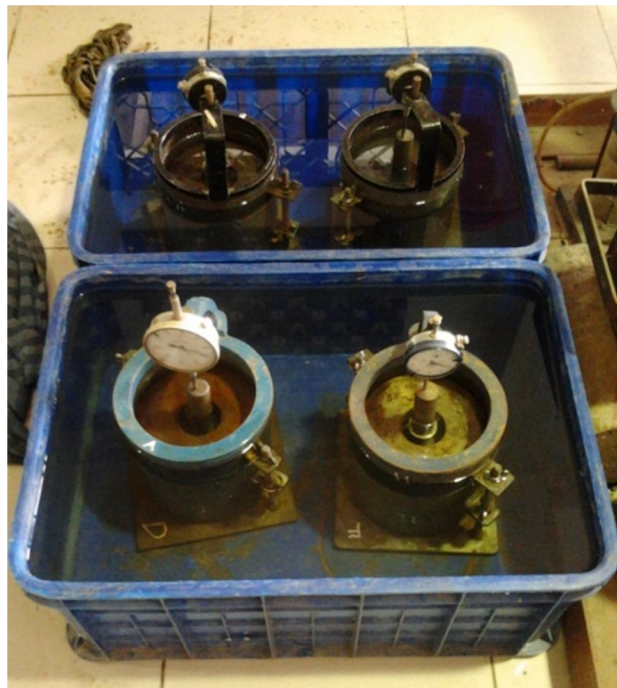
Gambar 4.8 Proses perendaman untuk mengetahui nilai pengembangan.
