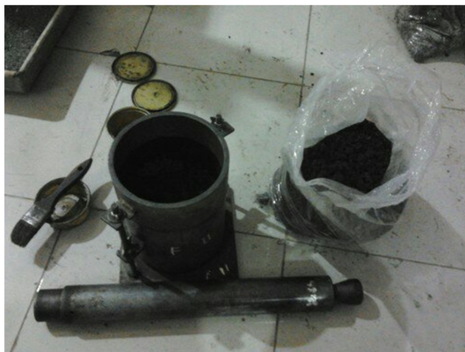
Gambar 4.5 Silinder pemadatan CBR dan penumbuk.
