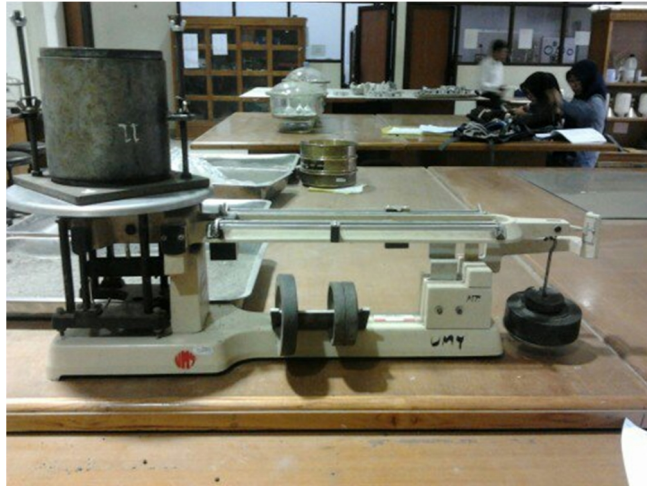
Gambar 4.6 Penimbangan tanah dalam silinder sebelum diuji penetrasi CBR.
