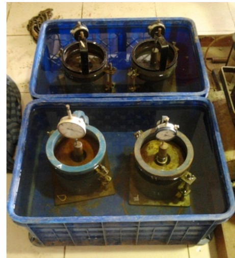
Gambar 4.3 proses perendaman untuk mengetahui nilai pengembangan.
