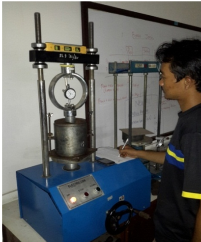
Gambar 4.2 proses penetrasi CBR.
