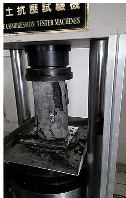
Gambar 5.10 Pola kerusakan beton
