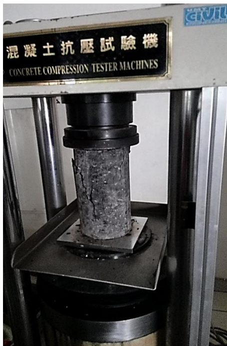
Gambar 5.9 Pola kerusakan beton
