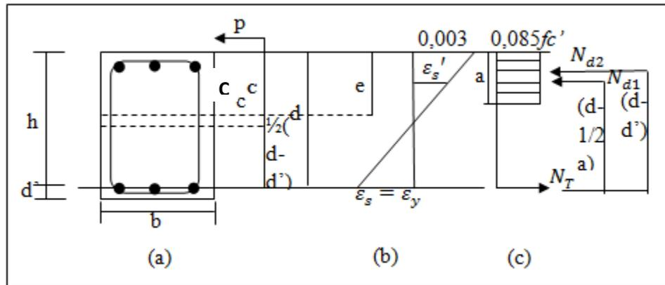
Gambar 3. 4 Penampang persegi kolom tulangan dalam keadaan seimbang (a) Penampang kolom, (b) Diagram regangan (c) Tegangan dan gaya-gaya dalam pada kolom.
