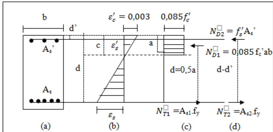
Gambar 3.2 Penampang persegi tulangan rangkap, (a) Penampang balok, (b) Diagram regangan, (c) Diagram gaya tulangan tunggal dan pasangan kopel
