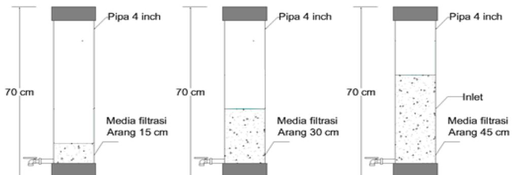
Gambar 4.4 Alat uji model filtrasi media filtrasi arang batok.
