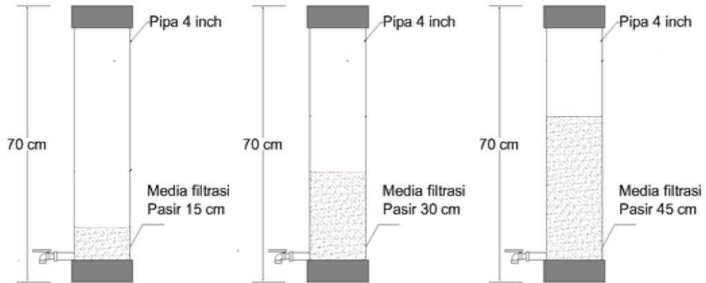
Gambar 4.2 Alat uji model filtrasi media filtrasi pasir
