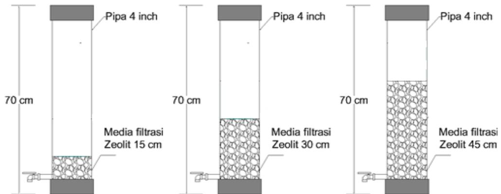
Gambar 4.3 Alat uji model filtrasi media filtrasi zeolit.
