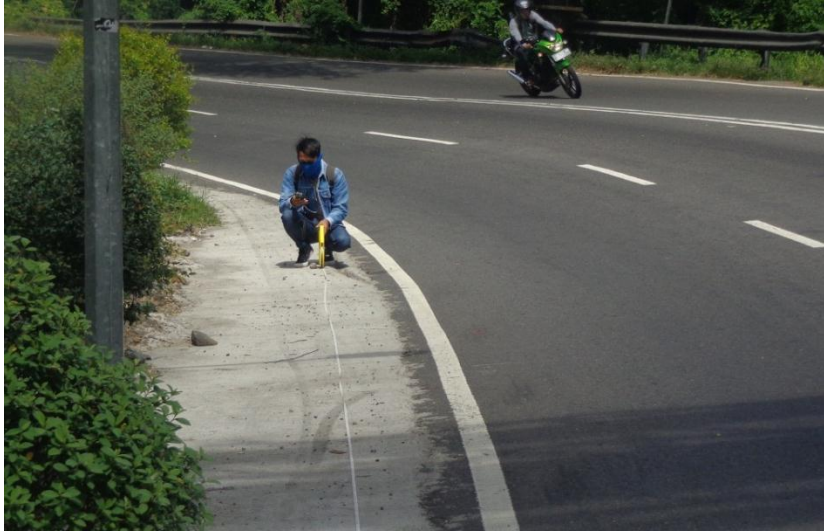
Gambar 4.3. Pengambilan data panjang jalan dan pengukuran titik stasionyng per 25 meter.
