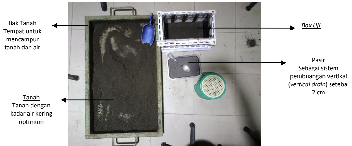
Gambar 3.17 Pencampuran tanah dengan air
