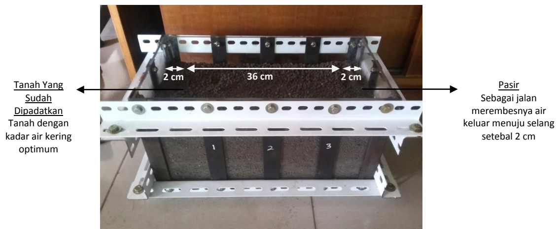
Gambar 3.18 Tanah yang telah dipadatkan ke dalam box uji
