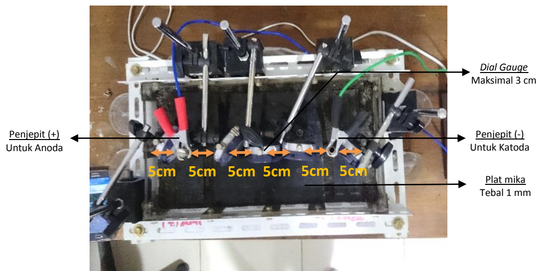
Gambar 3.20 Pemasangan Plat Mika, Magnetic Dial Gauge dan kabel beserta penjepit
