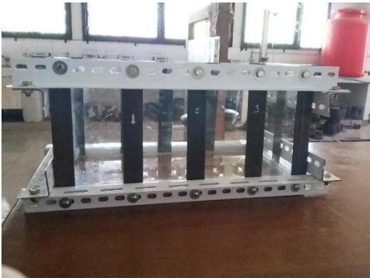
Gambar 2. Box Uji Elektrokinetik
