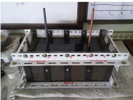
Gambar 3. Pemadatan dan Pemasangan elektroda
