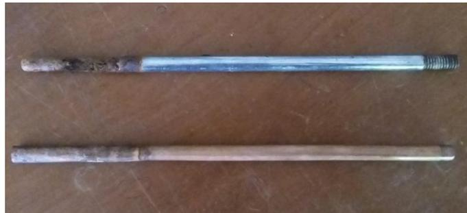
Gambar 13. Elektroda anoda (besi) dan katoda (tembaga) mengalami keropos
