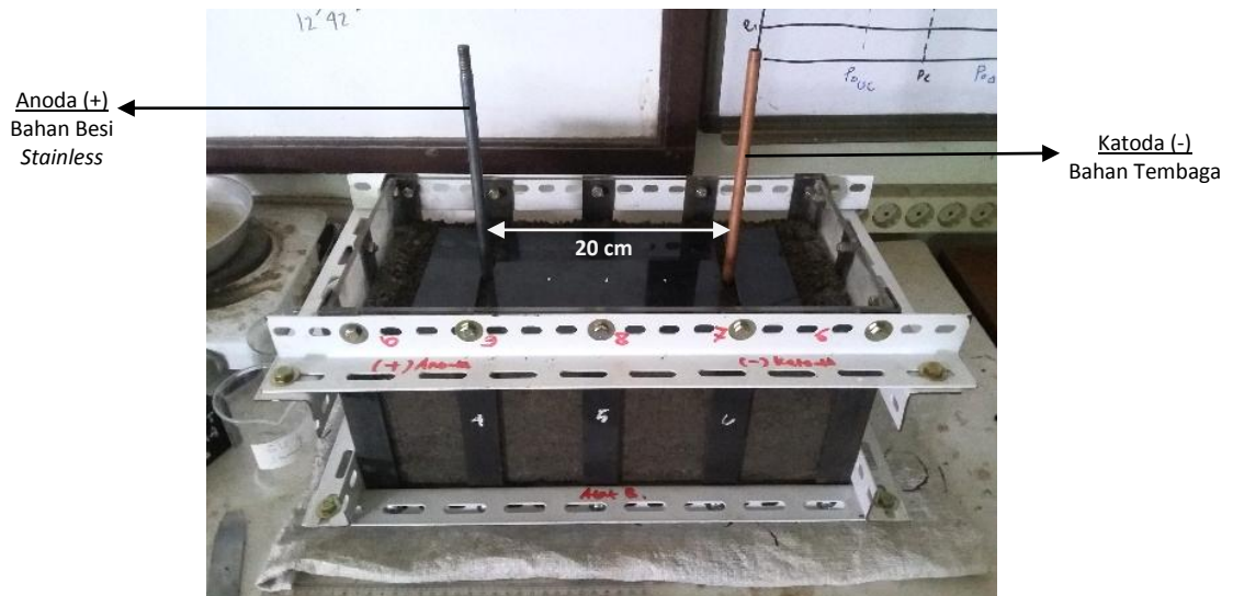
Gambar 3.18 Pemasangan Elektroda
