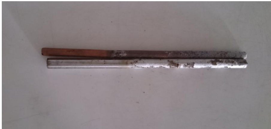
Gambar 4.15 Elektroda anoda (besi stainless ) dan katoda (tembaga) mengalami keropos
