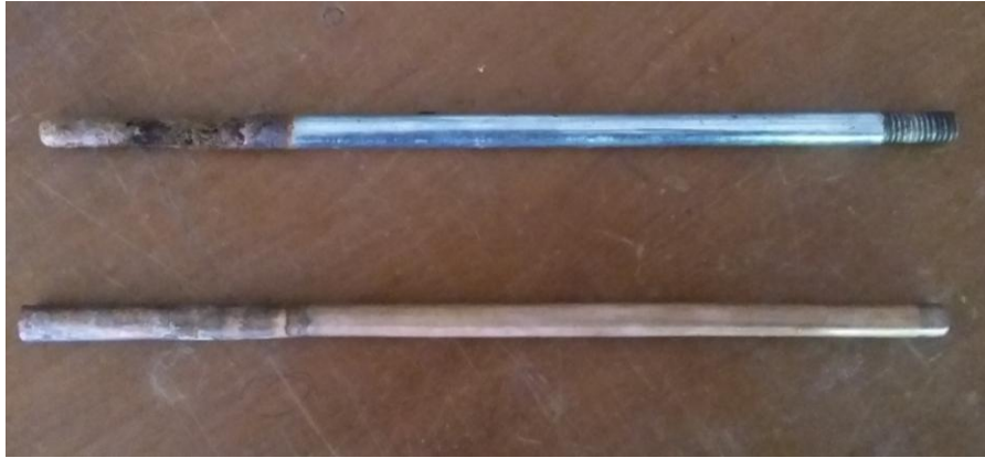
Gambar 4.14 Elektroda anoda (besi) dan katoda (tembaga) mengalami keropos
