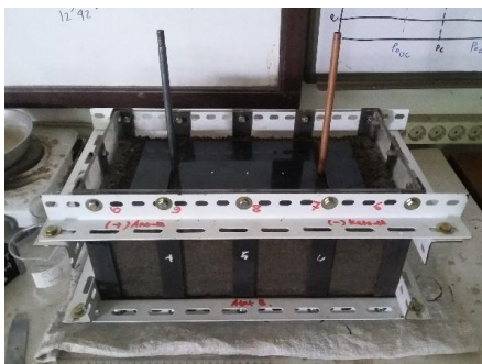
Gambar 3. Pemadatan dan Pemasangan elektroda
