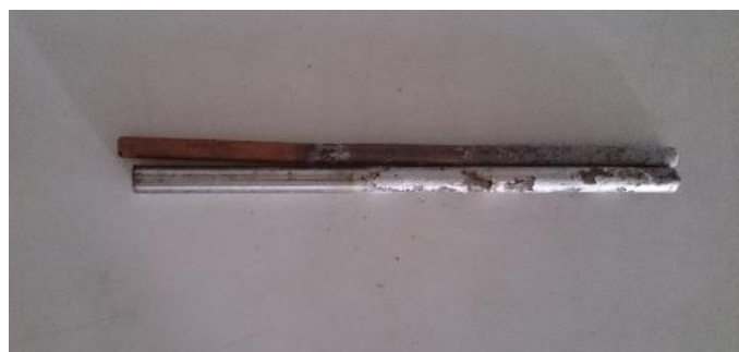
Gambar 14. Elektroda anoda ( besi stainless ) dan katoda (tembaga) mengalami keropos
