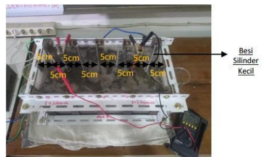
Gambar 5. Pengujian besaran voltase setiap titik
