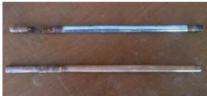
Gambar 13. Elektroda anoda (besi) dan katoda (tembaga) mengalami keropos
