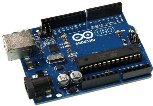
Gambar 1. Bentuk fisik arduino dan sistem arduino
