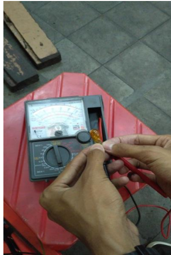
Gambar 3.16. Pemeriksaan tahanan bohlam signal tanda belok
