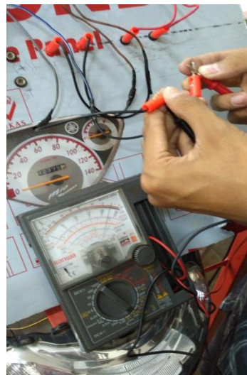
Gambar 3.19. Pengukuran kontinuitas relay
