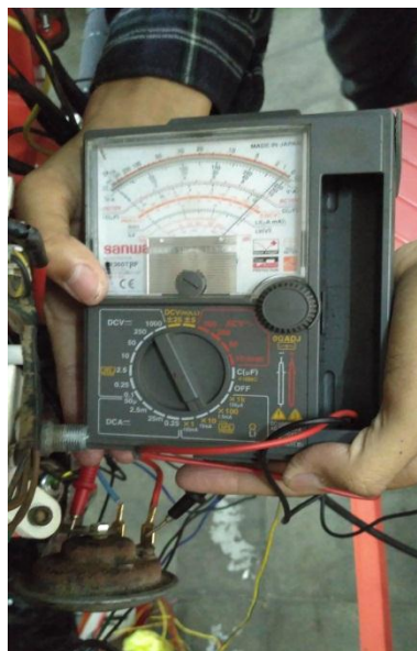
Gambar 3.13. Pengukuran tegangan pada terminal klakson
