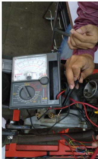
Gambar 3.21 Penmeriksaan kontinyuitas motor starter
