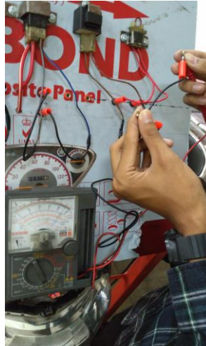
Gambar 3.20. Pengukuran tegangan coupler signal belok
