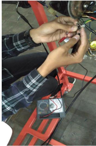
Gambar 3.6. Pengukuran tegangan coupler lampu kepala
