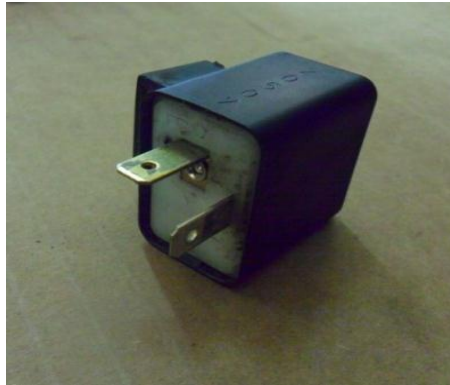
Gambar 2.20. Flasher pada sepeda motor Yamaha Mio
