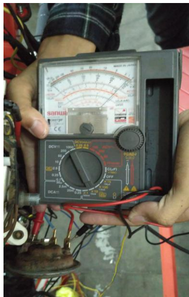
Gambar 3.13. Pengukuran tegangan pada terminal klakson
