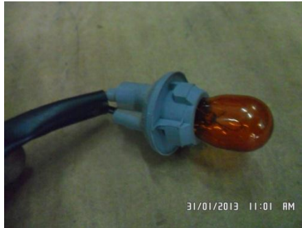
Gambar 2.17. Bola lampu sein dan dudukanya pada Yamaha Mio (otosportmaniak, 2016)
