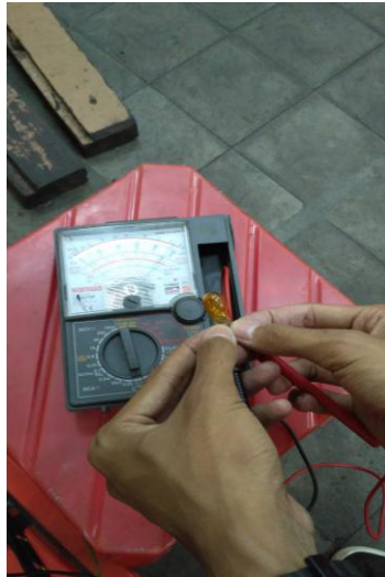
Gambar 3.16. Pemeriksaan tahanan bohlam signal tanda belok
