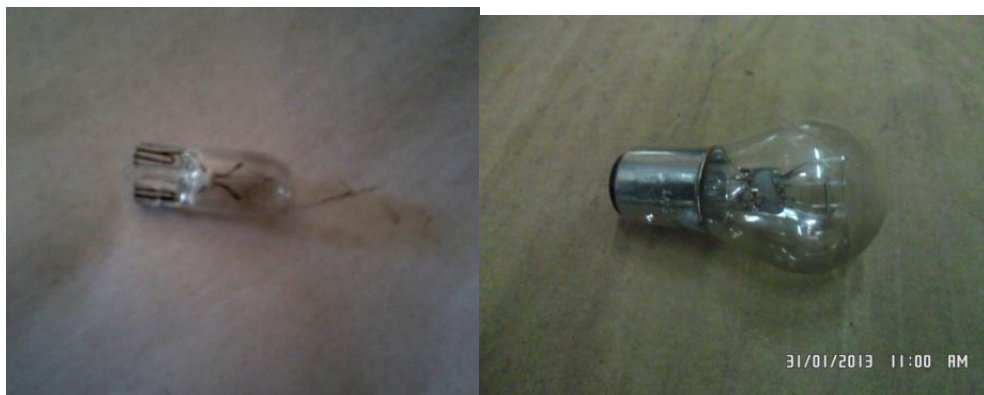
Gambar 2.10. Bola lampu kota depan dan belakang pada Yamaha (otosportmaniak, 2015)
