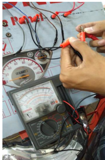
Gambar 3.19. Pengukuran kontinuitas relay
