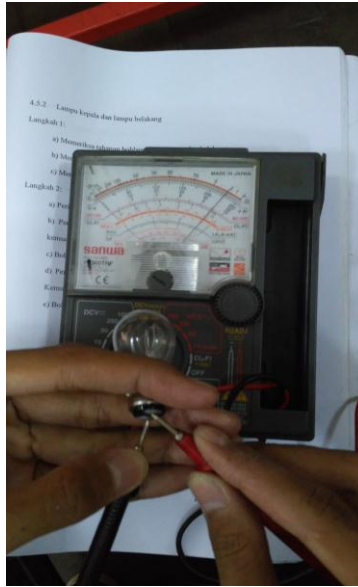
Gambar 3.15. Pemeriksaan tahanan pada bohlam lampu rem
