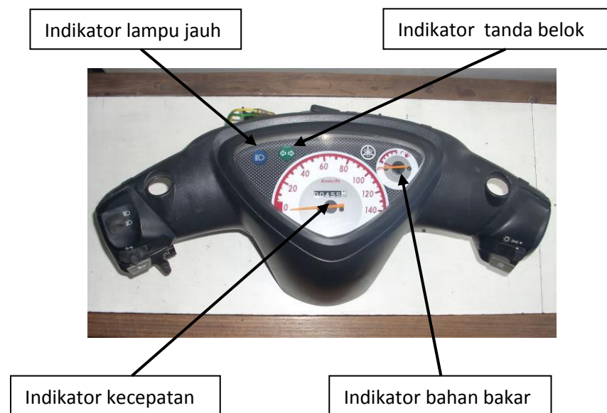
Gambar 2.24. Indikator-indikator pada Yamaha Mio (otosportmaniak, 2016)
