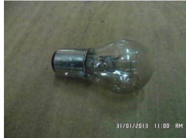
Gambar 2.16. Bola lampu rem pada Yamaha Mio (otosportmaniak, 2016)
