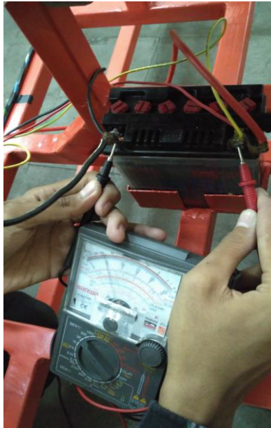
Gambar 3.3. Pengukuran tegangan baterai
