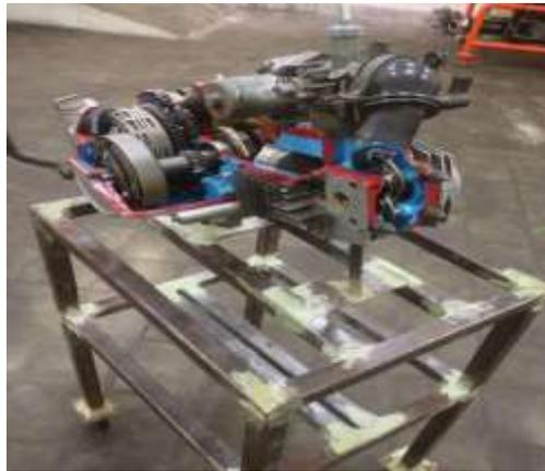
Gambar 4.10. Dudukan *Engine* Setelah Dipasang *Engine*
