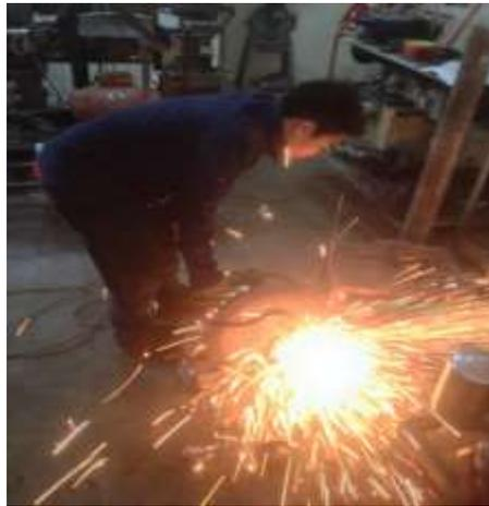
Gambar 4.7. Proses Pemotongan Besi Bahan
