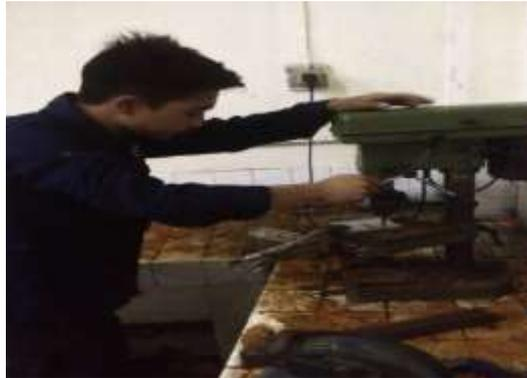
Gambar 4.11. Pembuatan Dudukan Roda *Engine Stand*
