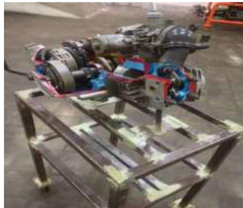
Gambar 4.22. Merangkai *Engine* Ke *Stand*
