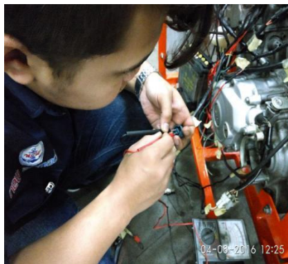
Gambar 4.4. Memeriksa Hubungan Kabel Orange/Hitam Antara Connector Fuel Injector Dan Connector ECU
