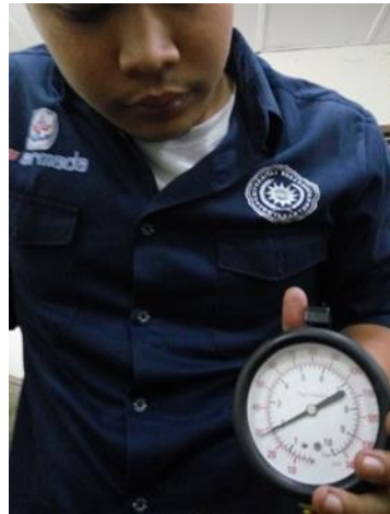
Gambar 4.1 Pengukuran Tekanan Bahan Bakar
