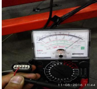
Gambar 4.10. Memeriksa Hubungan Kabel Merah Jambu/Putih Antara Connector Intake Air Pressure Sensor Dan Connector ECU
