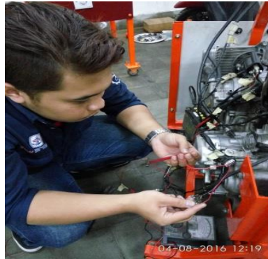
Gambar 4.6. Memeriksa Hubungan Connector FID
