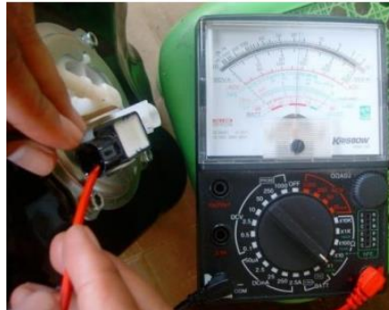
Gambar 4.2. Pengukuran Tahanan Pompa Bahan Bakar
