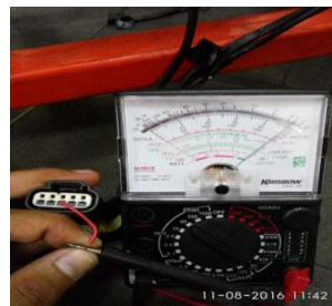
Gambar 4.9. Memeriksa Hubungan Kabel Hitam/Biru Antara Connector Intake Air Pressure Sensor Dan Connector ECU
