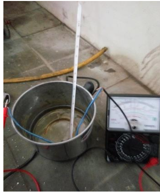
Gambar 4.7. Memeriksa Tahanan Fast Idle Solenoid
