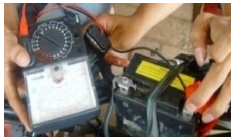
Gambar 4.5. Memeriksa Hubungan Kabel Merah Antara Battery Dan Connector ECU
