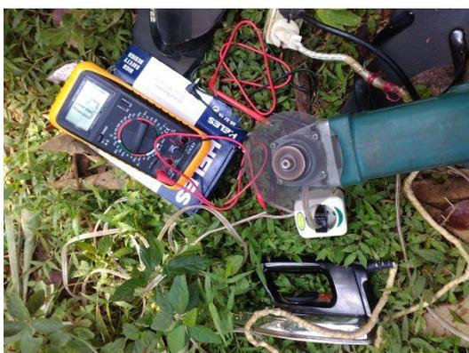
Penulis melakukan percobaan dengan menggunakan beban setrika dengan daya 300 watt dan gurinda tangan dengan daya 400 watt. Tegangan yang terukur ketika menggunakan setrika sebesar 70.2 volt dan arus yang terukur adalah 0.46 amper. Tegangan yang terukur ketika menggunakan setrika sebesar 67.2 volt dan arus yang terukur adalah 0.62 amper.
