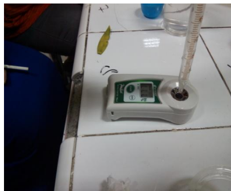
Pengujian zat padat terlarut dengan refraktometer
