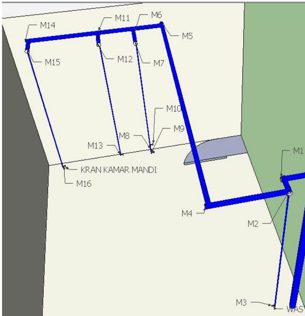
Gambar 4. Skema pipa lantai dasar kamar mandi wanita
