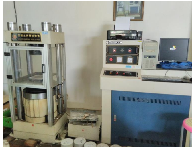
Gambar 6. Mesin uji tekan beton Merk Hung Ta
