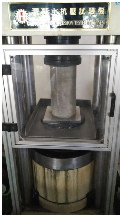
Gambar 32. Pengujian kuat tekan
