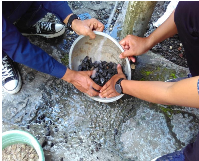
Gambar 21. Pencucian agregat kasar
