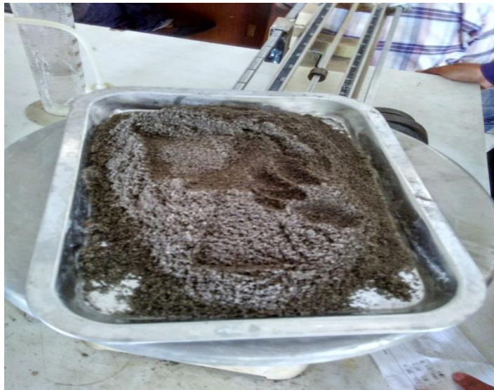
Gambar 23. Proses penimbangan untuk takaran semua material
