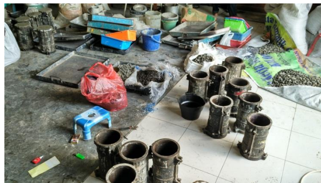
Gambar 26. Persiapan silinder/cetakan beton
