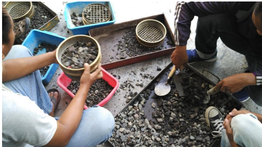
Gambar 22. Proses pengayakan agregat halus/kasar
