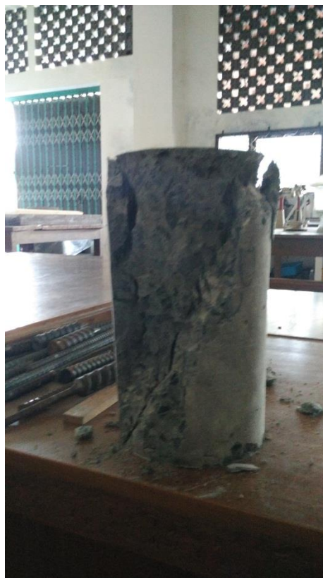
Gambar 33. Beton setelah dilakukan pengujian
