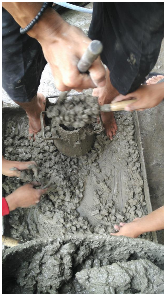
Gambar 28. Pemadatan beton segar kedalam silinder/cetakan
