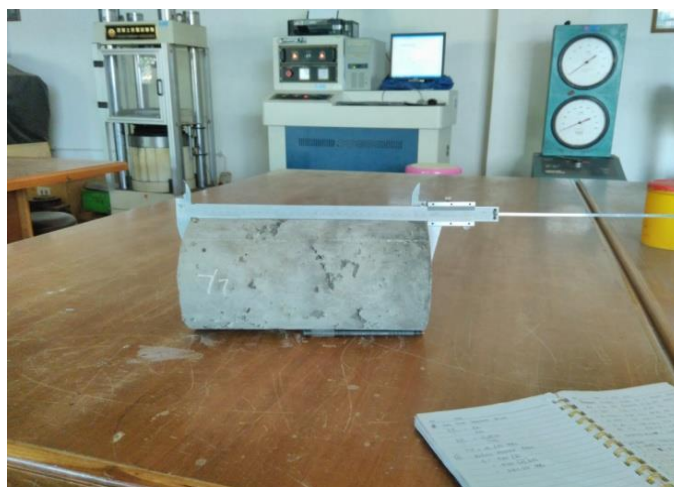
Gambar 31. Pengukuran tinggi beton
