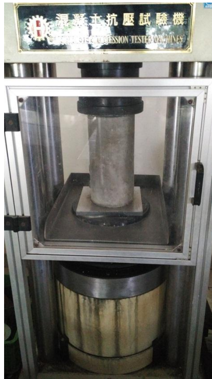
Gambar 31. Pengujian kuat tekan
