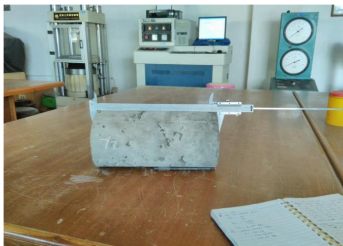
Gambar 30. Pengukuran tinggi beton
