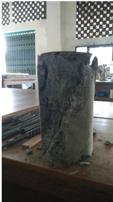
Gambar 32. Beton setelah dilakukan pengujian
