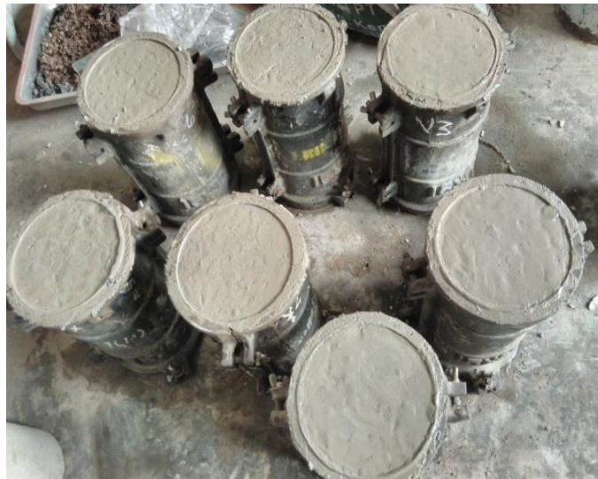
Gambar 28. Beton segar yang telah dipadatkan
