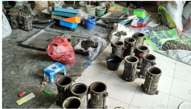
Gambar 25. Persiapan silinder/cetakan beton
