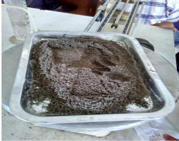
Gambar 22. Proses penimbangan untuk takaran semua material
